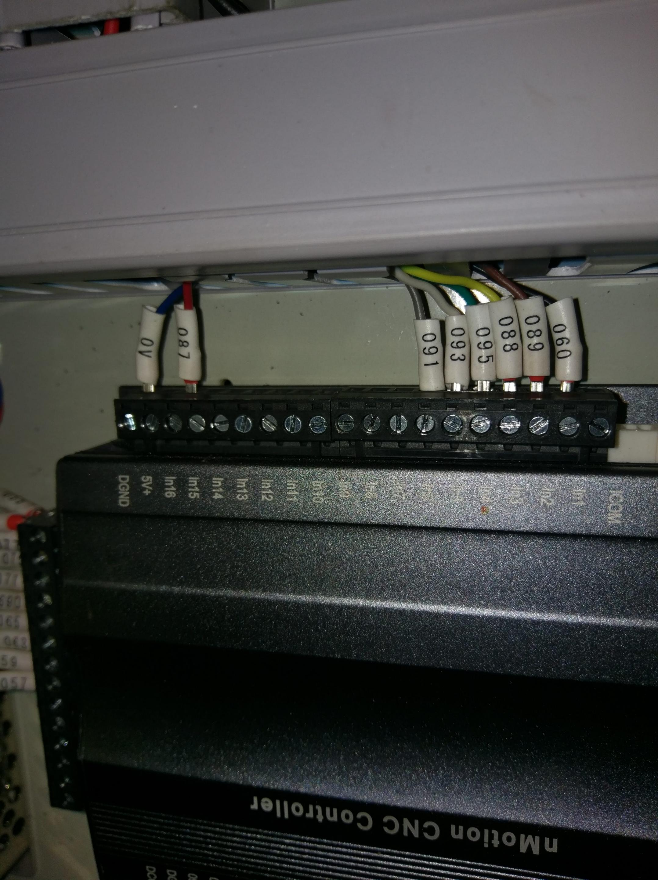
DGND 5V+ In16 In15 In14 In13 In12 In11 In10 In9 In8 In7 In6 In5 In4 In3 In2 In1 ICOM
